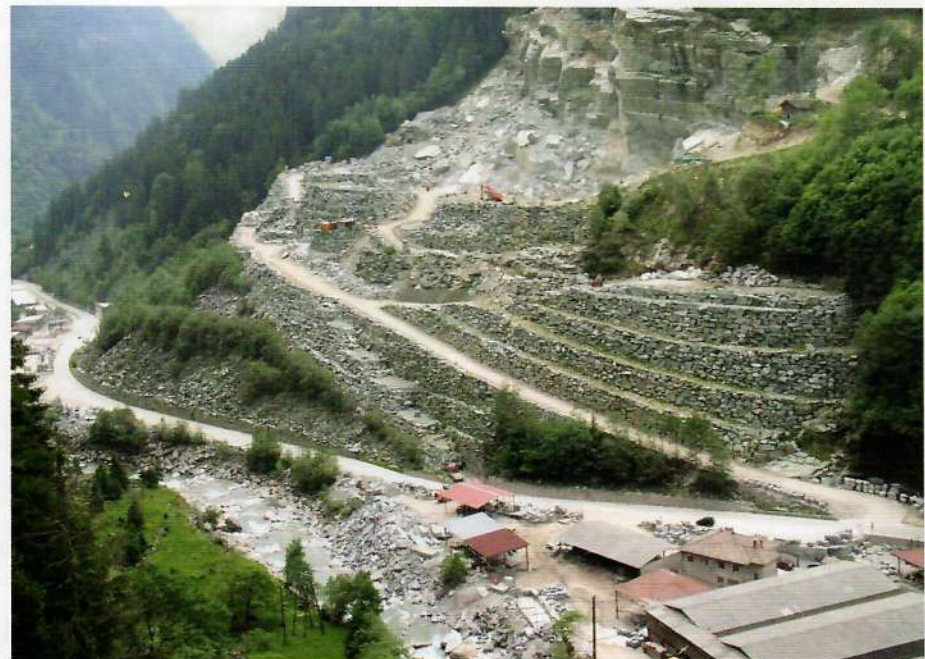
Abb. 12: Steinbruch Arvigo baut Gneis für Bauzwecke auf der talwärts geneigten Schieferung ab
