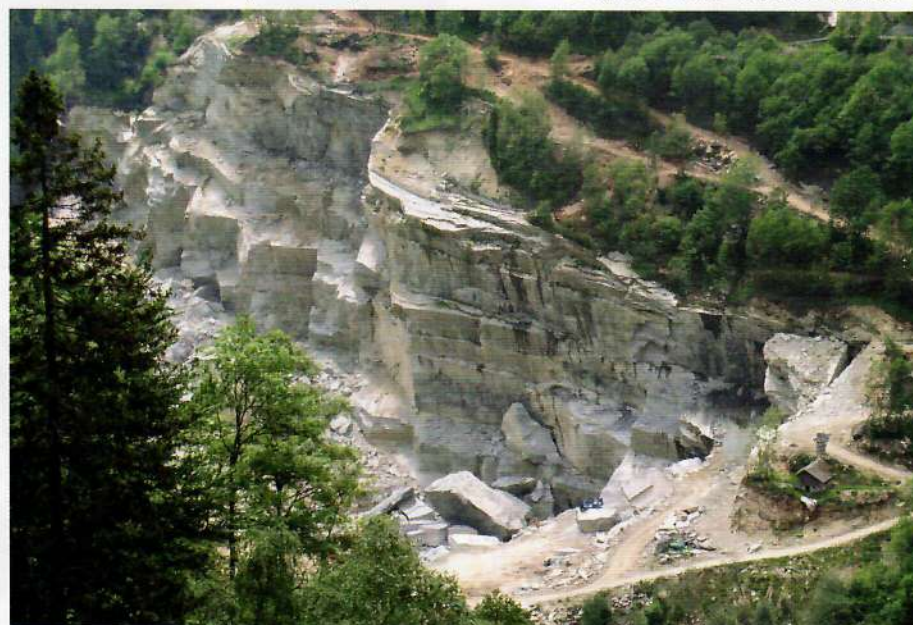
Abb. 15: Stand Abbau 2001, wo entlang der verwinkelten Talklüfte „kleine Zähne“ abgebaut wurden
